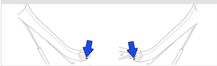
**3** Снимите **накладку** ручки двери багажного отделения.
