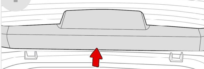
**2** Выверните **2 винта** и снимите левую и правую боковые облицовочные панели двери багажного отделения.
