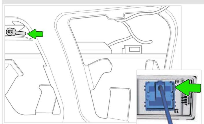
**7** Отверните **2 винта TORX 6** крепления камеры к штатному кронштейну и установите камеру на новый кронштейн.
