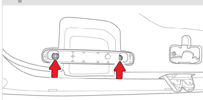
**5** Открутите **2 самореза** крепления нижней облицовочной панели двери багажного отделения, освободите клипсы и снимите панель.
