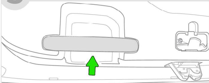
**4** Выверните **2 винта** крепления и снимите ручку двери багажного отделения.
